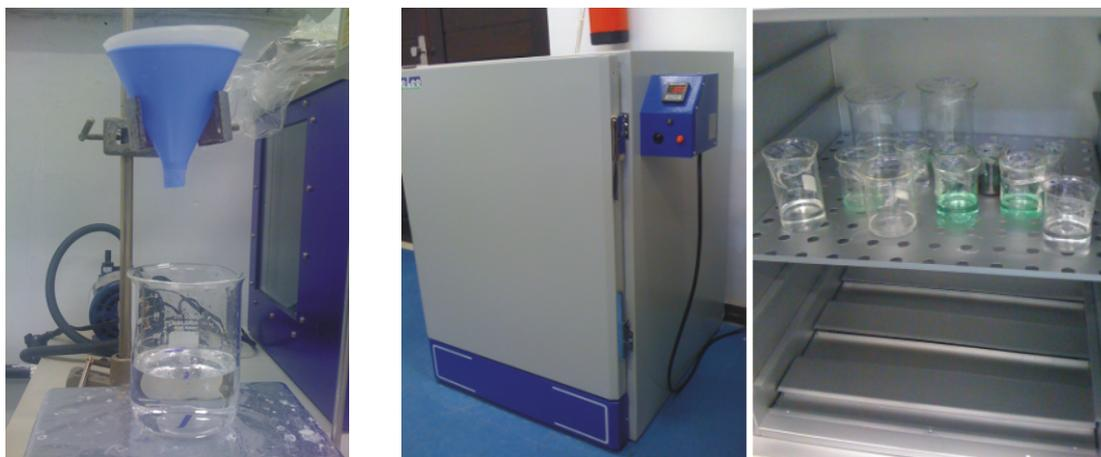
Figura 21: (a) Filtragem da solução supersaturada, (b) Armazenamento da solução com filme de PVC
