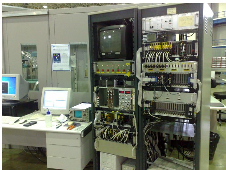
Figura 27: Equipamentos para a coleta de dados fornecidos pela DRX ou DMRX.
