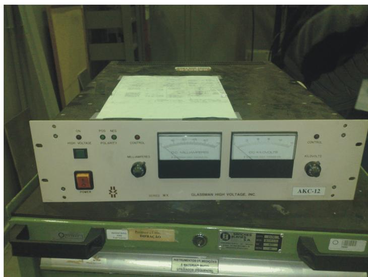
Figura 30: Fonte de alta tensão utilizada na estação XRD1.
