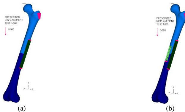
Figura 5.22 – Aplicação de deslocamentos nulos, nos modelos: (a) modelo uma placa; (b) modelo duas placas.
