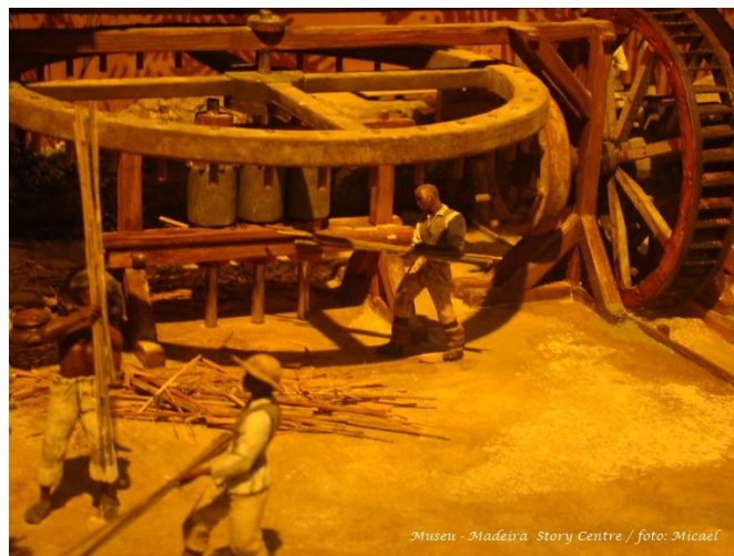
Figura 5 – Reprodução em escala de uma moenda movida a água.
