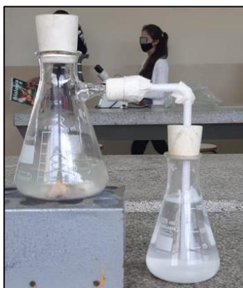
Figura 60 – Esquema para se observar a formação de  $\text{CaCO}_{3(s)}$  (*Fonte: Arquivos da pesquisa*).
