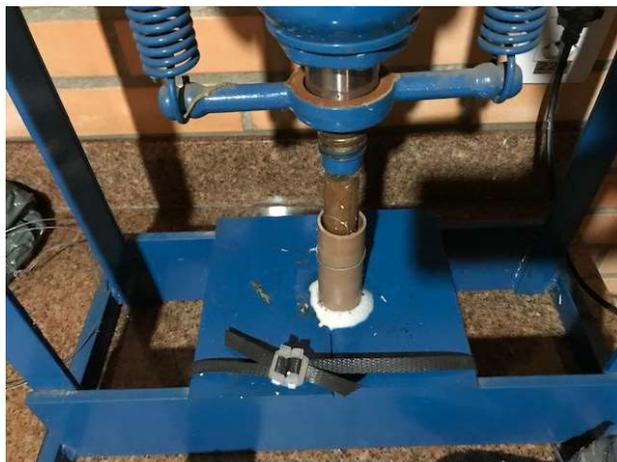
Figura 4.18 – Prensagem de amostra de 29 mm (Autor)
