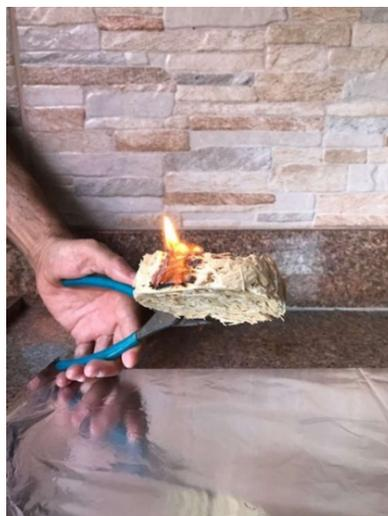
Figura 5.15 – Amostra sem adição de solução retardante a chamas submetida ao fogo (Autor)
