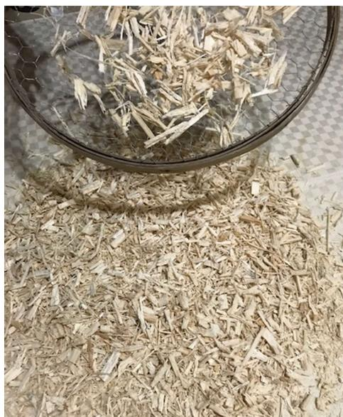
Figura 4.13 – Colmo do bagaço da cana-de-açúcar peneirado em dispositivo com malha de 35 mm (Autor)
