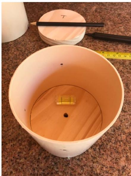
Figura 4.6 – Molde para conformação de amostras de 100 mm de diâmetro (Autor)
