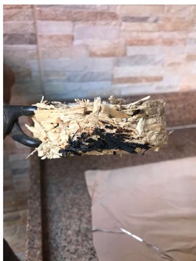
Figura 5.14 – Resultado final após submissão da amostra com adição de solução retardante a chamas ao fogo (Autor)
