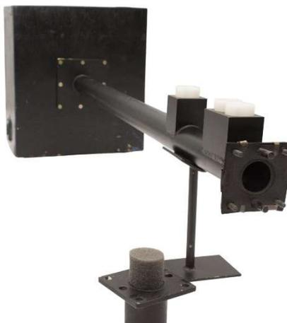
Figura 4.24 - Tubo de impedância de 27,7 mm do laboratório de acústica da UFSM (Prof. Paulo H. Mareze, EAC-UFSM)
