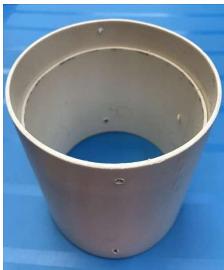
Figura 4.7 – Molde para conformação de amostras de 96 mm de diâmetro (Autor)
