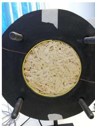
Figura 4.34 – Amostra 2 com lateral envolvida por EVA posicionada no tubo de impedância (Prof. Paulo H. Mareze, EAC-UFSM)
