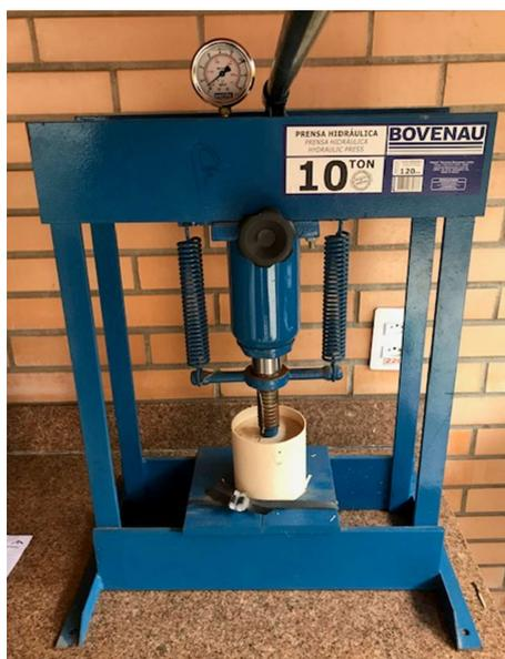
Figura 4.17 – Prensagem de amostra de 100 mm (Autor)
