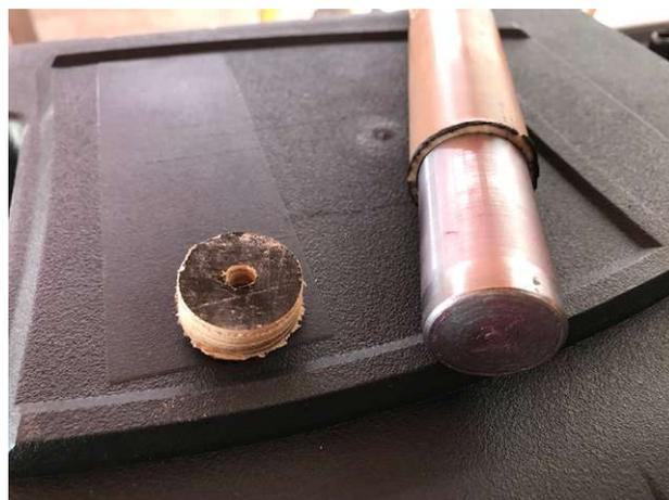
Figura 4.8 – Molde para conformação de amostras de 27 mm de diâmetro (Autor)
