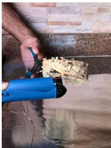
Figura 5.13 – Amostra com adição de solução retardante a chamas submetida ao fogo (Autor)
