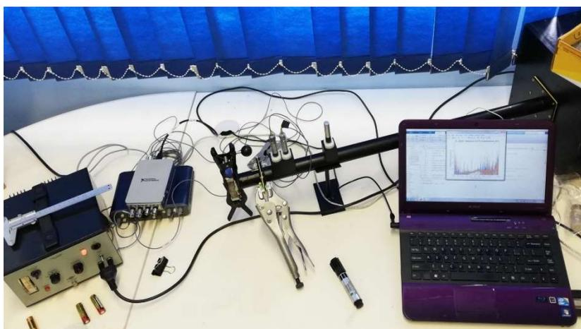
Figura 4.25 – Kit do tubo de impedância de 27,7 mm do laboratório de acústica da UFSM (Prof. Paulo H. Mareze, EAC-UFSM)
