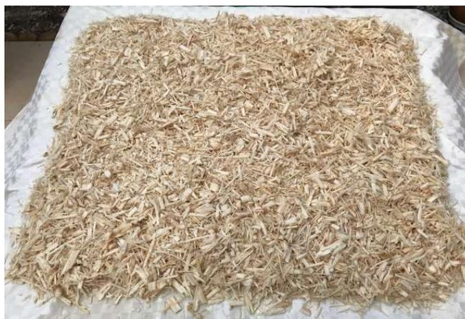
Figura 4.14 – Colmo do bagaço da cana-de-açúcar em seu processo de secagem pós lavagem (Autor)
