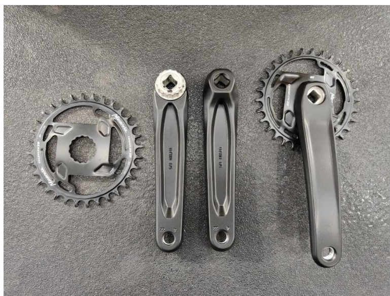
Figura 6 - Roda dentada, cranque direito, cranque esquerdo e roda cravada no cranque direito.
