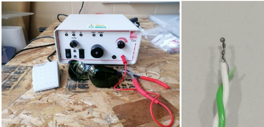
Figura 2.1. Equipamento de soldadura (esquerda) da junção de um termopar tipo-K (direita).
