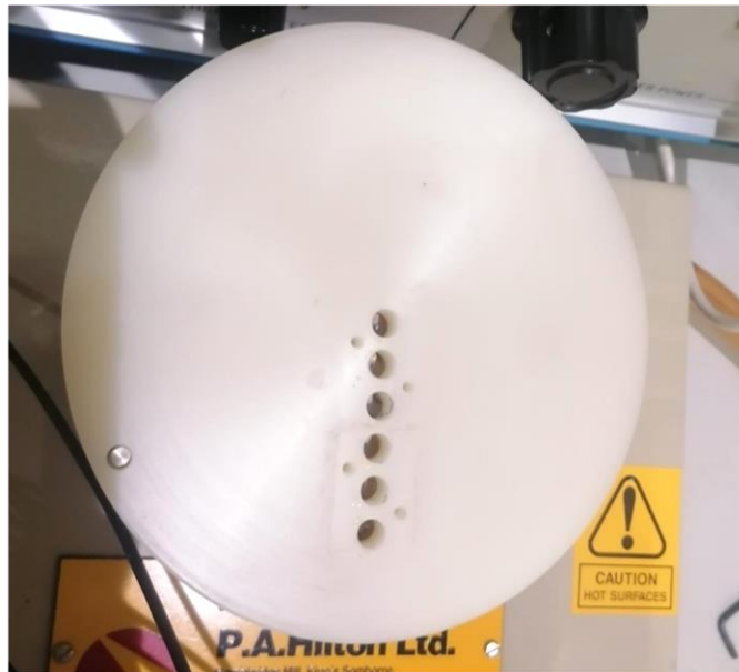
Figura 1.10. Módulo radial de condução de calor
