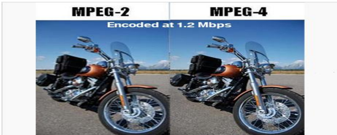
Figura 2.5 - Diferenças entre os codecs MPEG-2 e MPEG-4 numa transmissão a 1.2 Mbps [13]
