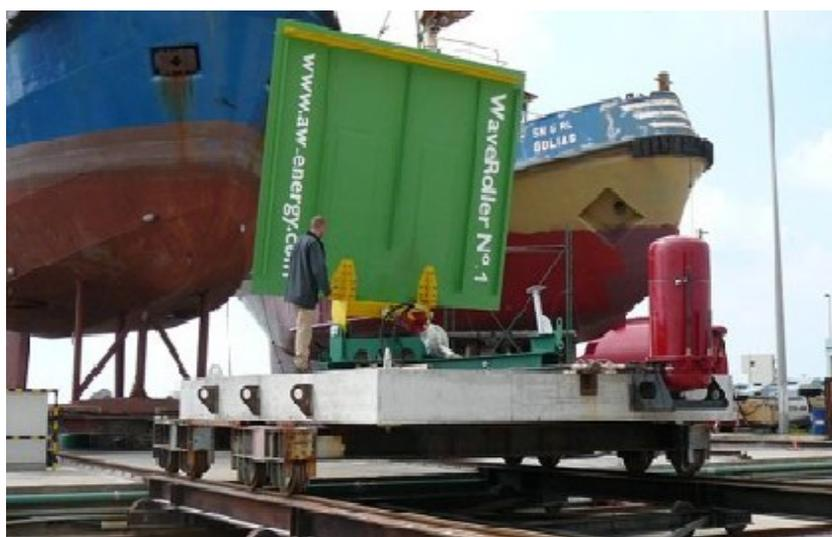
Fotografia 5.1 – Protótipo do *WaveRoller* nos Estaleiros Navais de Peniche
