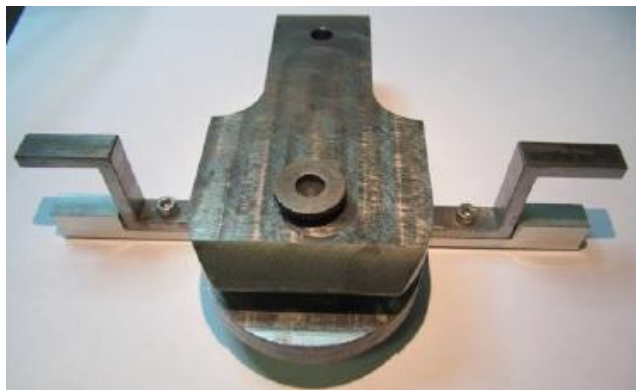
Figura 5.4. Uma das amarradas utilizadas para fixar o provete ao tensómetro. (14)
