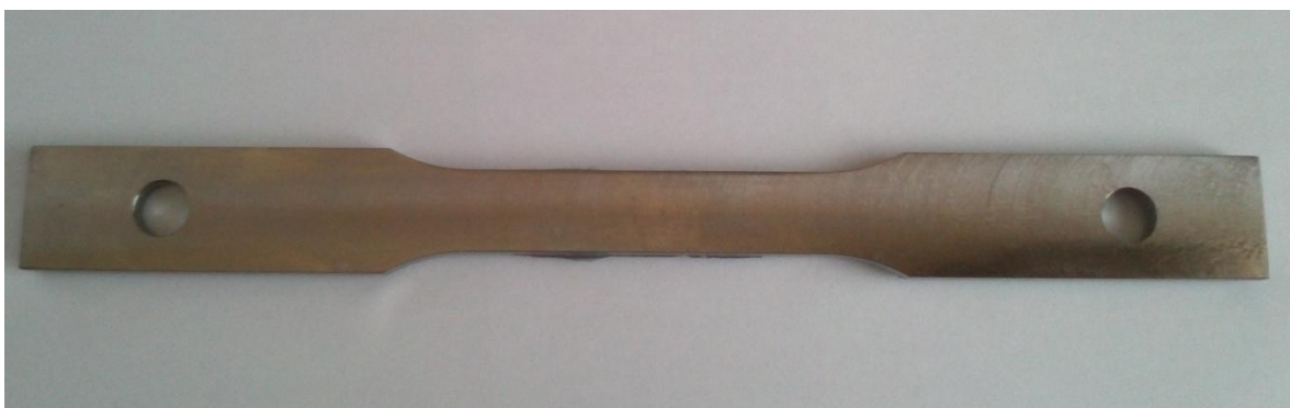
Figura 4.2. Provete de Ti-6Al-4V utilizado nos ensaios experimentais.
