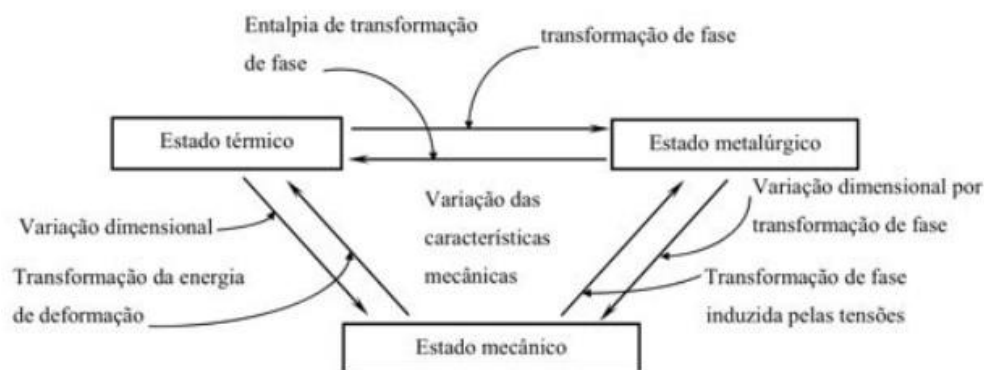
Figura 2.2. Origem das tensões residuais.(3)
