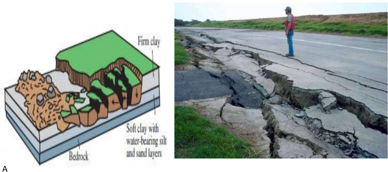
Figura 2.11 – A) Esquema de uma expansão lateral (lateral spreading) (Highland & Browsky, 2008); B) Imagem de uma expansão lateral, Watsonville, (E.U.A.), 1989 (U.S. Geological Survey).
