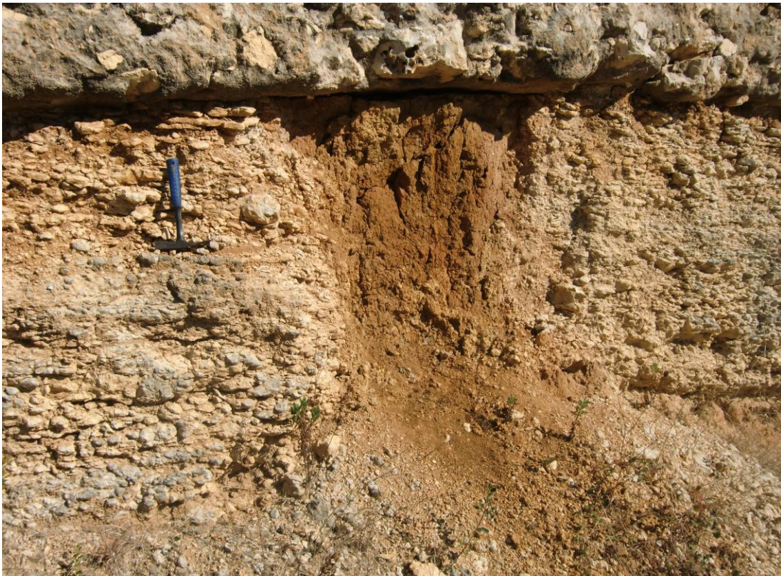
Figura 3.13 – Formação Carbonatada - Calcários apinhoados margosos, com carsificação preenchida por depósitos argilosos com terra rosa. No centro podemos observar uma buraca.
