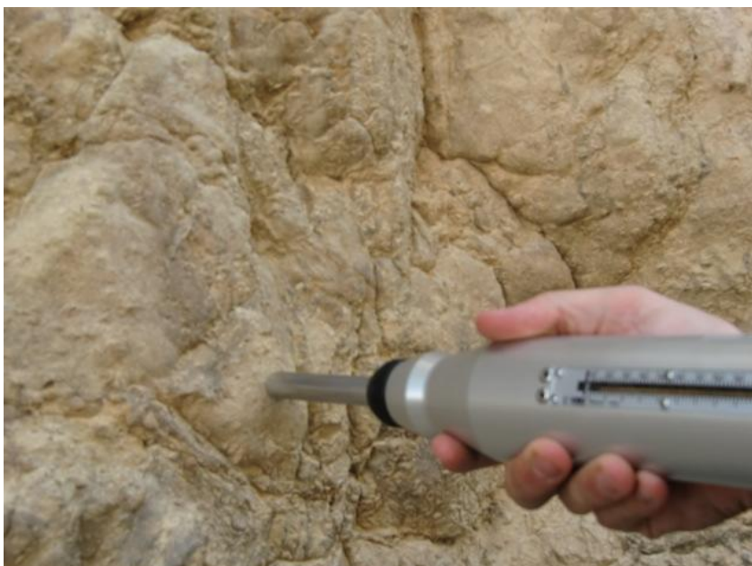
Figura 4.5 – Martelo de Schmidt, para determinação da dureza de Schmidt (R) nos ensaios “ in situ ”
