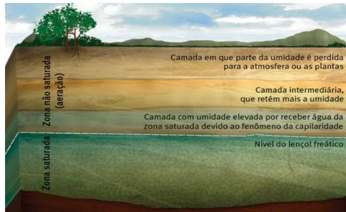
Figura 1.3 - Distribuição das águas no solo (Adaptado de MELO et al. , 2010)
