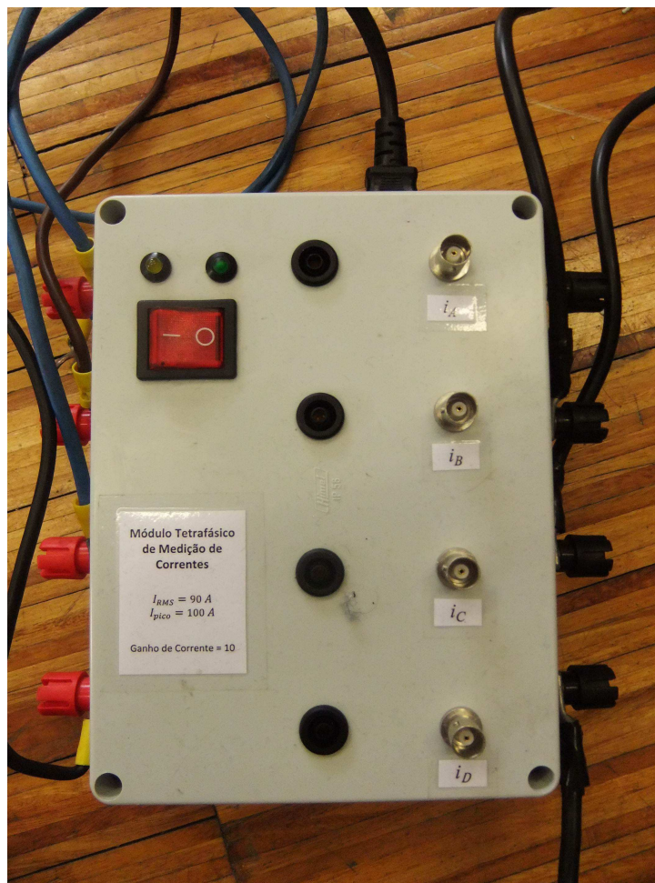
Figura III.2: Módulo tetrafásico de medição de correntes, com sensores LEM LA-100P.
